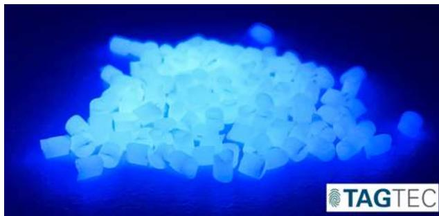
Além disso, o TAGTEC também pode ser detectado nos flocos de plástico, bem como no material reciclado, pois as partículas marcadoras do TAGTEC são resistentes a temperaturas de até 900 °C. Assim, o ciclo de rastreabilidade do produto pode ser fechado, permitindo o monitoramento contínuo da cadeia de suprimentos, praticamente de pellet para pellet.
